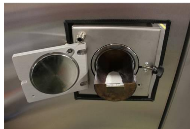
P260 laitteen höyrystinkammio jauhemaisen Dimeerin syöttöön
